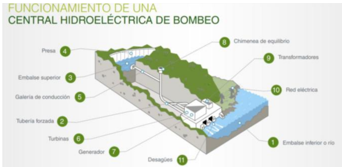
Figura 5: Funcionamiento de una central hidroeléctrica reversible. Fuente: Redacción de El Periódico de la Energía, s.f.
