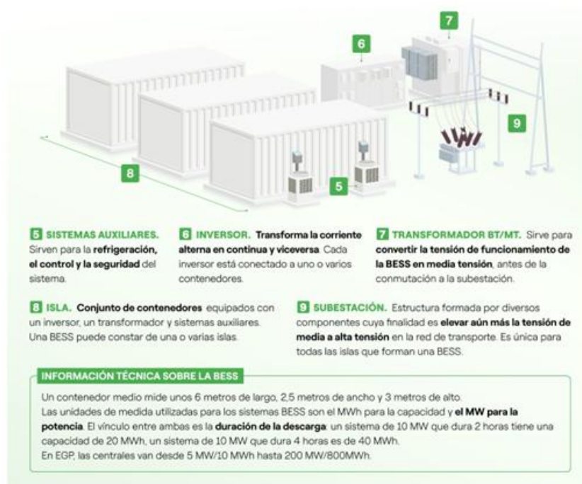
Figura 17: Esquema de un sistema BESS 2/2. Fuente: Enel Green Power, s.f.
