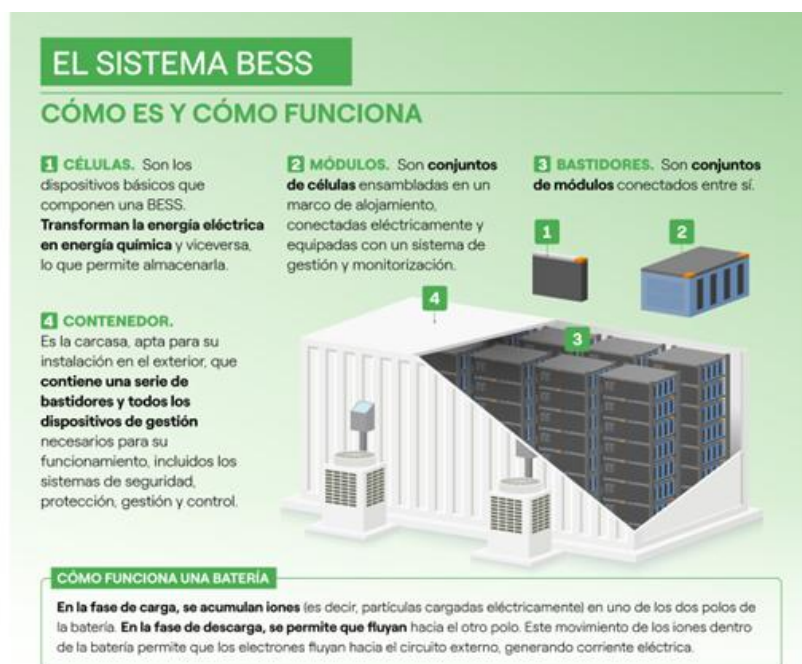
Figura 16: Esquema de un sistema BESS 1/2. Fuente: Enel Green Power, s.f.
